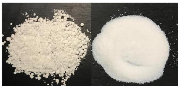
图 1 左图为天然硅藻土填料；右图为安捷伦最新的合成式 SLE 填料。
