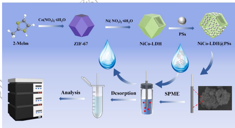
图 1 NiCo-LDH@PSs 涂层的制备以及测定环境水样中的多环芳烃示意图
