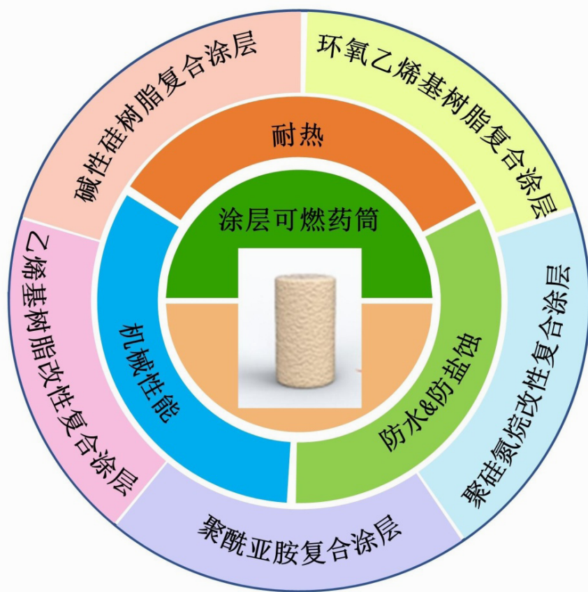
① 【图 14】复合涂层防护下的可燃药筒
