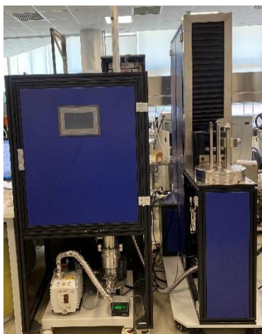
图 1 80-400 K大块体绝热量热仪器
