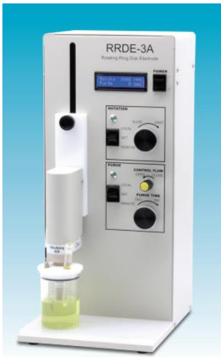
旋转环盘电极仪 RRDE-3A
