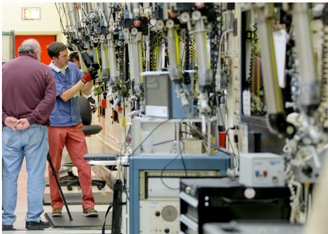
① 橡树岭国家实验室技术人员：在热室中操控机械臂，提取镭 - 225 及其他癌症治疗关键放射性同位素（左图来源：美国能源部橡树岭国家实验室，授权协议：CC BY-NC-ND；右图来源：贾森·理查兹（Jason Richards）/ 美国能源部橡树岭国家实验室，授权协议：CC BY-NC-ND）
