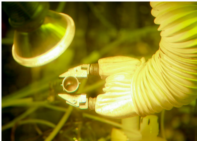
① 橡树岭国家实验室技术人员：在热室中操控机械臂，提取镭 - 225 及其他癌症治疗关键放射性同位素（左图来源：美国能源部橡树岭国家实验室，授权协议：CC BY-NC-ND；右图来源：贾森·理查兹（Jason Richards）/ 美国能源部橡树岭国家实验室，授权协议：CC BY-NC-ND）
