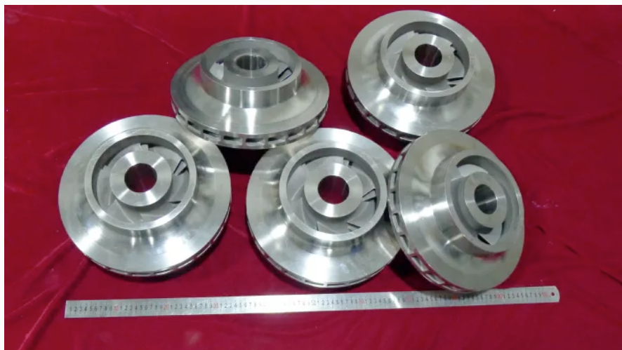
① 长征五号火箭氢泵叶轮。金属所供图
