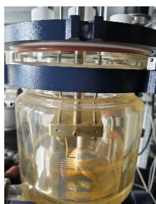
图 1 撞击流反应装置
