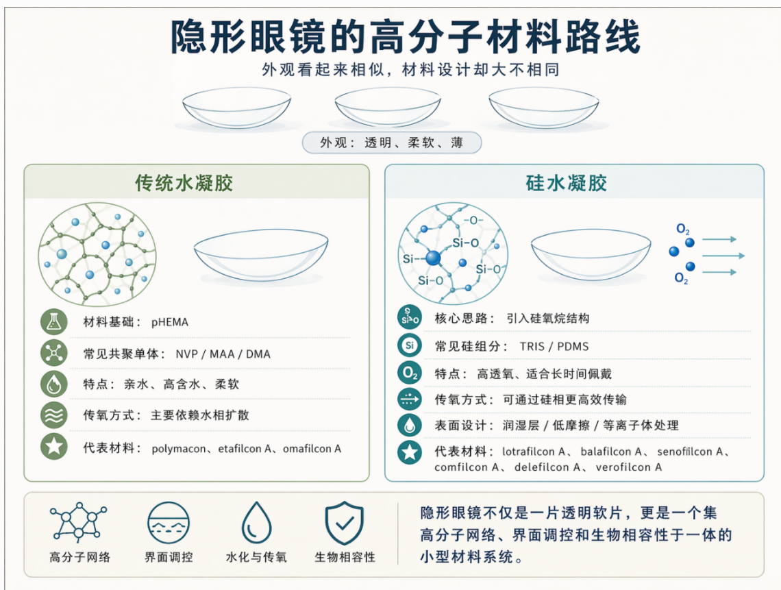
【图3】隐形眼镜材料分类示意图（图片来源于 Chat GPT 制作）
